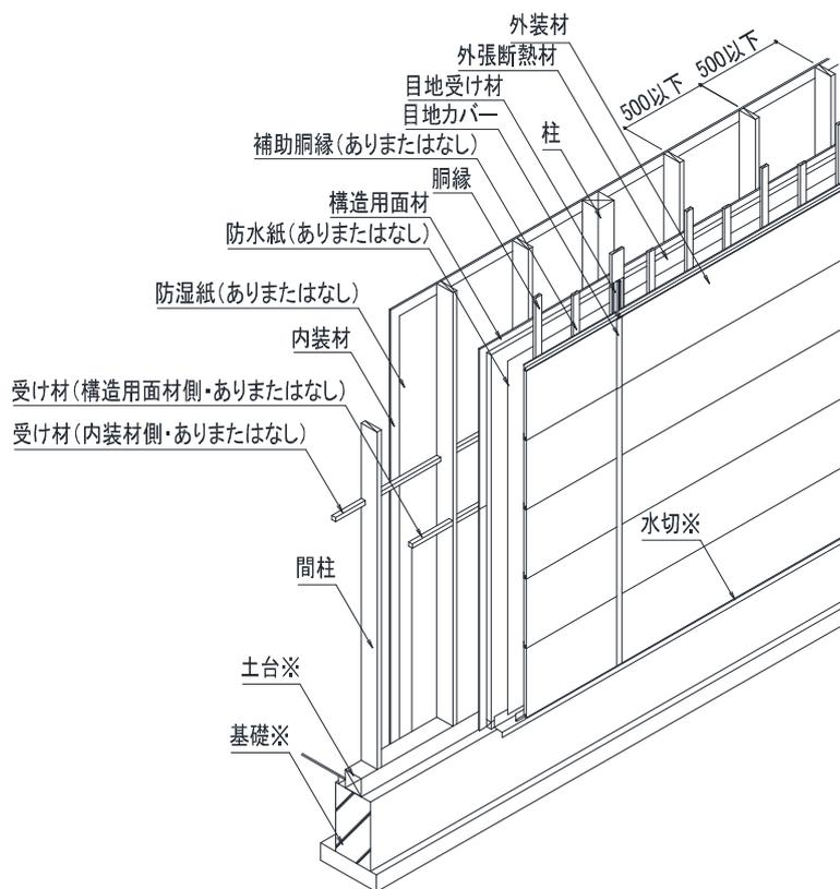
水平断面図(外装材：横張の場合)
