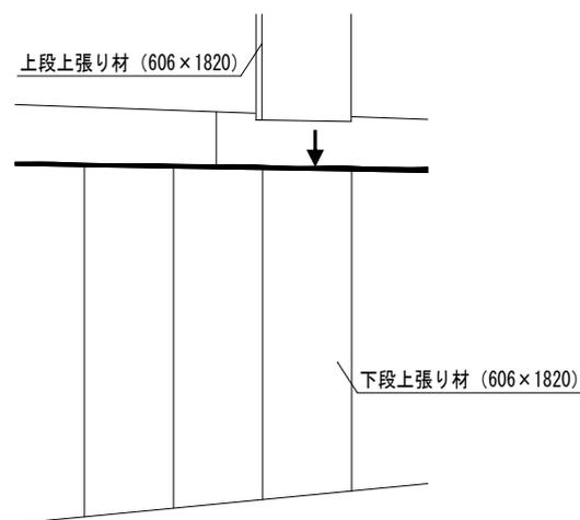
手順④：上段の上張り材を突き付け張りする。縦目地裏部には下段と同様にタイガーUタイトなどを塗布しながら、突き付け張りする。
