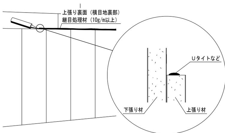
手順③：下段の上張り材を突き付け張りした後、横目地裏部にタイガーUタイトなどを塗布する。
