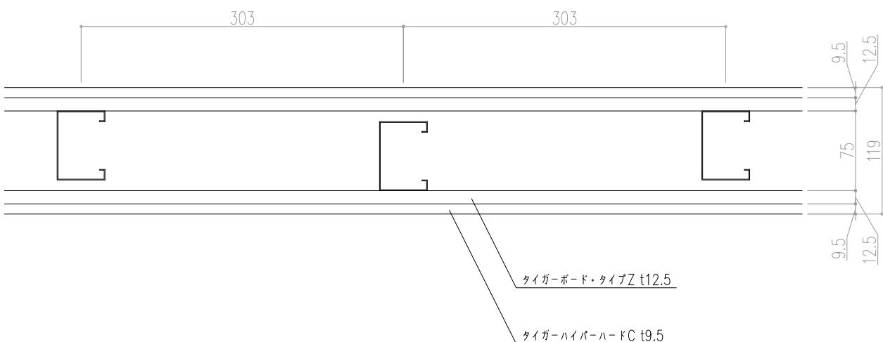
壁高さと鋼製下地材の選定例
