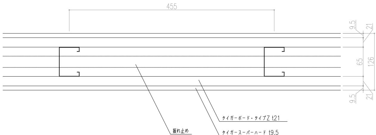
壁高さと鋼製下地材の選定例
