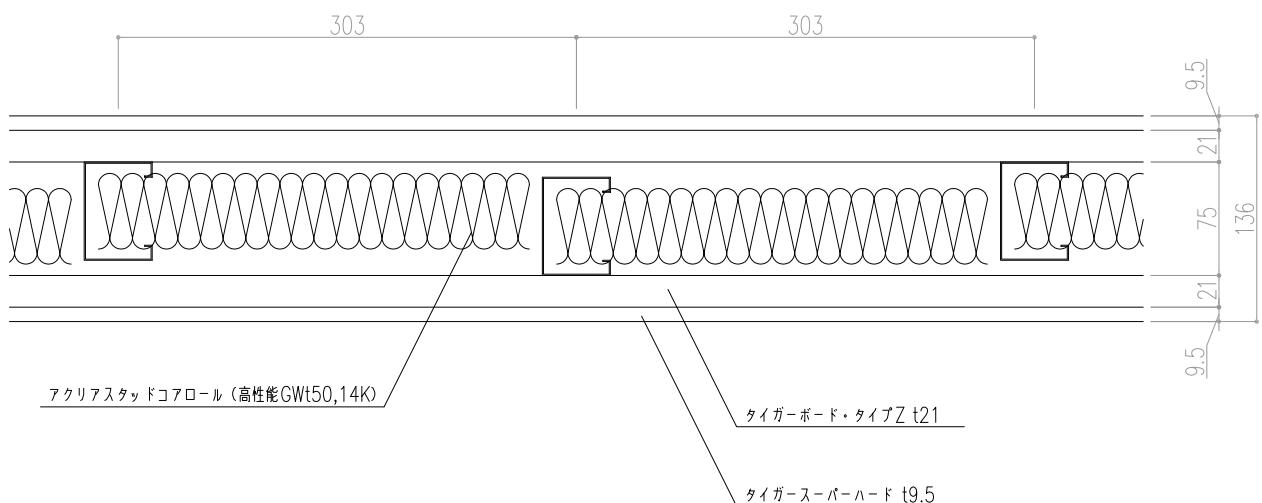
壁高さと鋼製下地材の選定例
