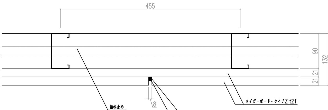
壁高さと鋼製下地材の選定例
