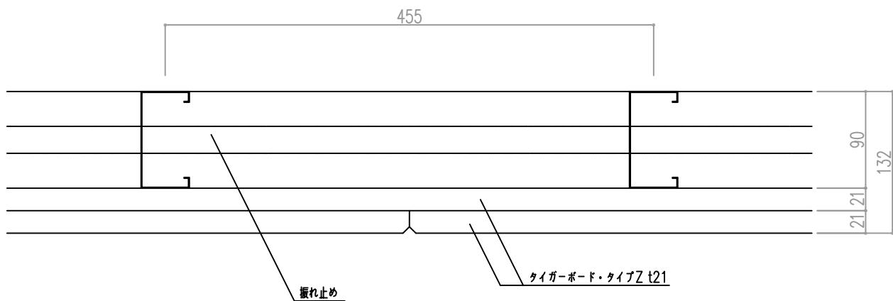
壁高さと鋼製下地材の選定例
