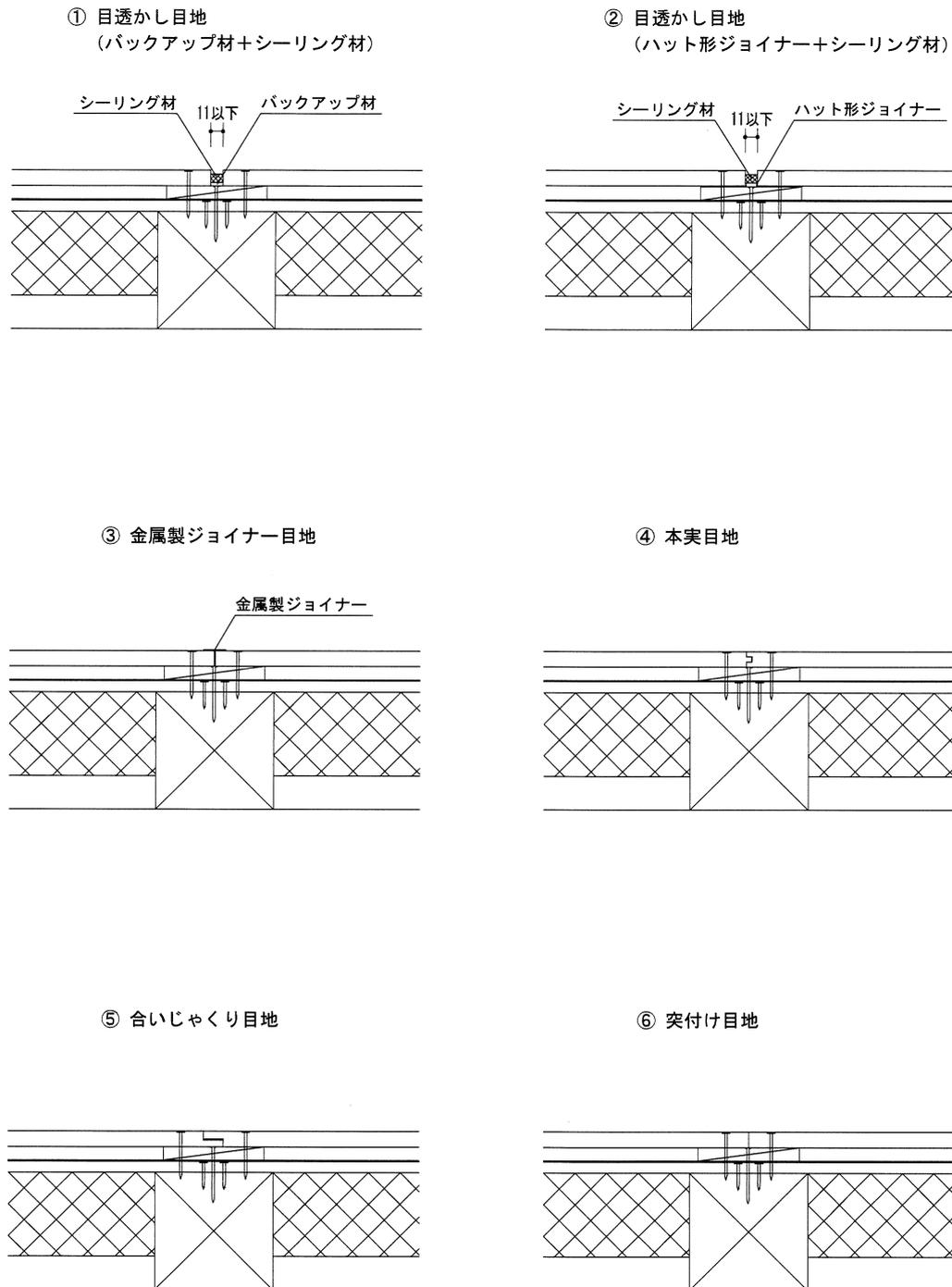
注) 寸法および材料構成は2および3のとおり
