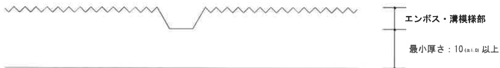
図- 8 外装材の端部形状及び断面形状の概略図
