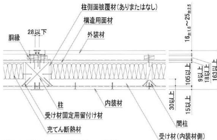
柱側面被覆材取付位置 (柱側面被覆材勝ちの場合)
