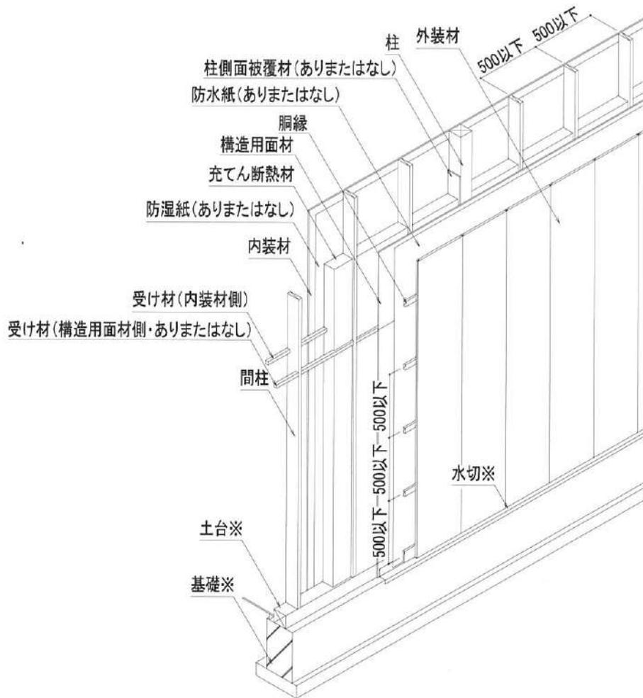
水平断面図(縦張の場合)
