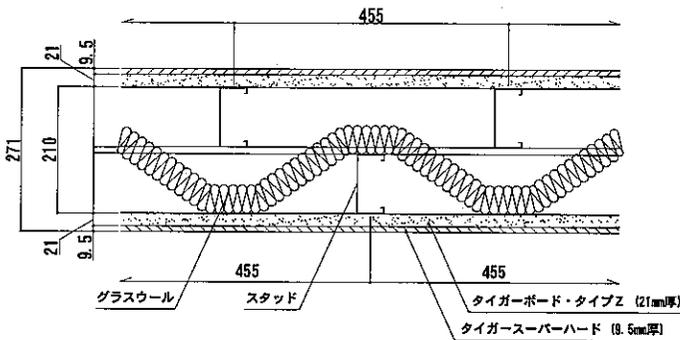
耐火認定工法のみを使用する場合の基本壁の水平断面図
