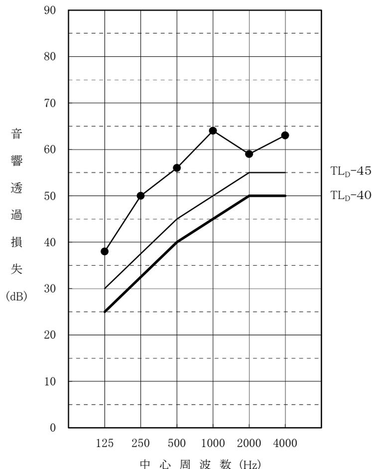
※上記の遮音性能測定値は、遮音壁の上張面材の継目及び壁四周の隙間処理を施した場合の数値です。
